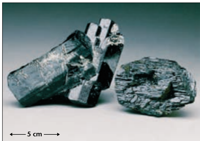
▲ Figura 3.25 Anfíbol hornblenda. La hornblenda es un silicato común oscuro que tiene dos direcciones de exfoliación que se cortan a 60^\circ y 120^\circ .
