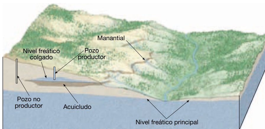
► Figura 17.6 Cuando un acuícluido está situado por encima del nivel freático principal, puede producirse una zona de saturación localizada. Donde el nivel freático colgado hace intersección con la ladera del valle, fluye un manantial. El nivel freático colgado también hizo que el pozo de la derecha diera agua, mientras que el de la izquierda no producirá agua a menos que sea perforado a una mayor profundidad.
